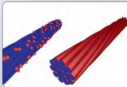
Les micro capsules lubrifient les fibres. Cela réduit les frictions et protège les fibres de l'usure et des déchirures.
